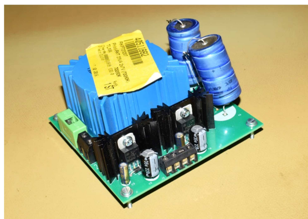
Fig. 6 De opgebouwde voeding. De elco zijn nog van het axiale type.
