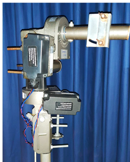
De twee Jaeger-rotors gemonteerd als elevatie/azimut
