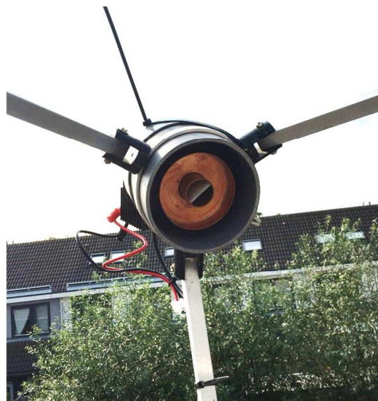
Feed voor 8GHz met delrin polarizer in de schotel bij Fred Jansen
