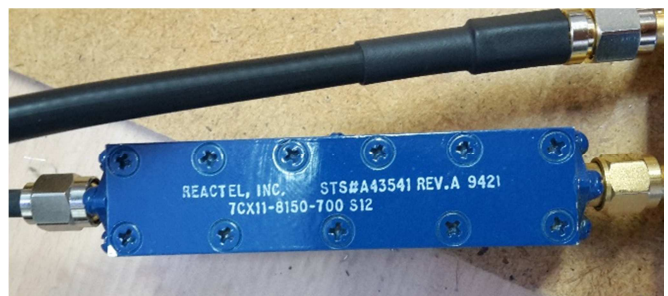
Fig 9 Het filter van Reactel, waarbij 8150 de centerfrequentie betekent en 700 de bandbreedte in MHz.
