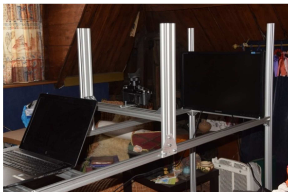
Fig 3 Aluminium constructie met camera en monitor. Links de laptop waar de monitor op is aangesloten
