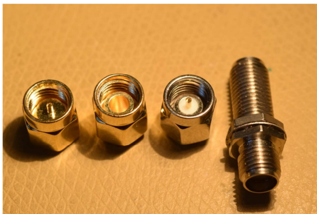
Fig 5 SOLT. Van links naar rechts: Short, Open, Load en Through
