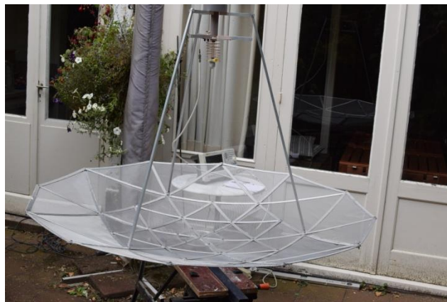
Fig. 10. De geodetische antenne is met een hoekprofiel op een werkbank vastgezet. Op de achtergrond de spectrum analyser voor het afregelen op het brandpunt.
