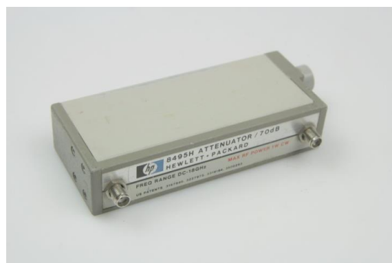
Fig 1 Een verzwakker van HP / Agilent / Keysight, afhankelijk van het fabricagejaar. Rechts zie je de aansluiting voor een zgn. Viking-connector.
