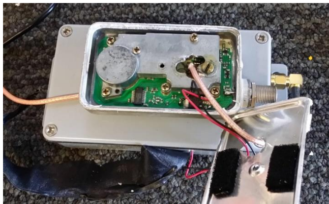
Fig. 1. Omgebouwde TV-LNB; de onderste doos bevat een PLL die 6300 MHz genereert; zie fig. 2.
