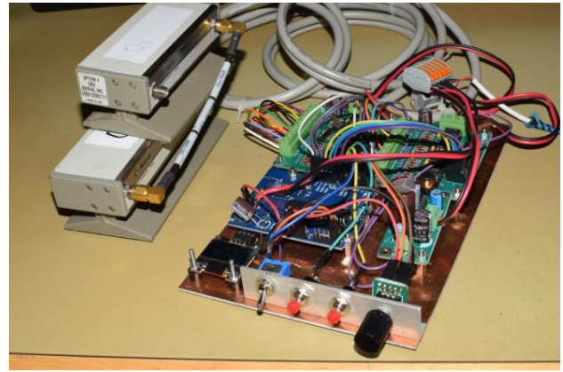
Fig. 7 Links de twee verzwakker en rechts de aansturing
