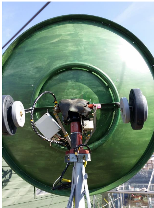
Fig. 6. De schotel aan de achterkant, met aangepaste Spid big Razz Rotors voor elevatie en azimut.
