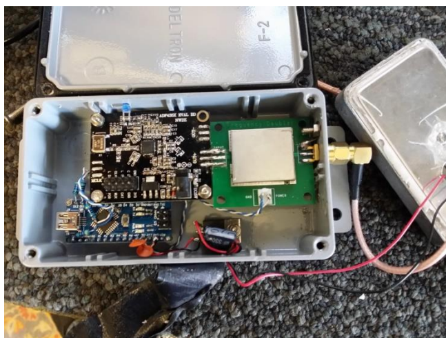
Fig. 2. De PLL, met onderop een Arduino als controller.
