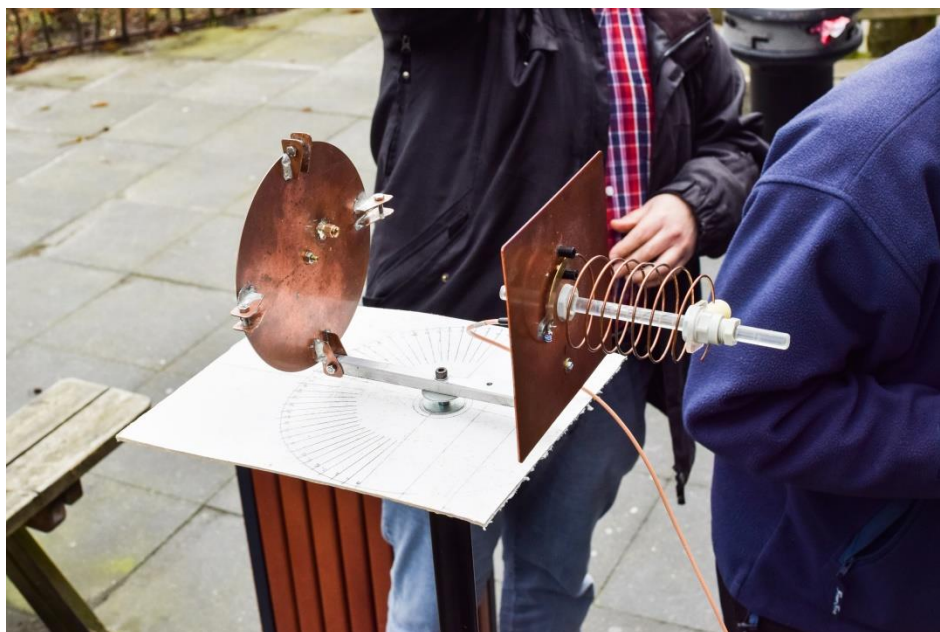
De zendantenne met de 2dBm synthesizer
