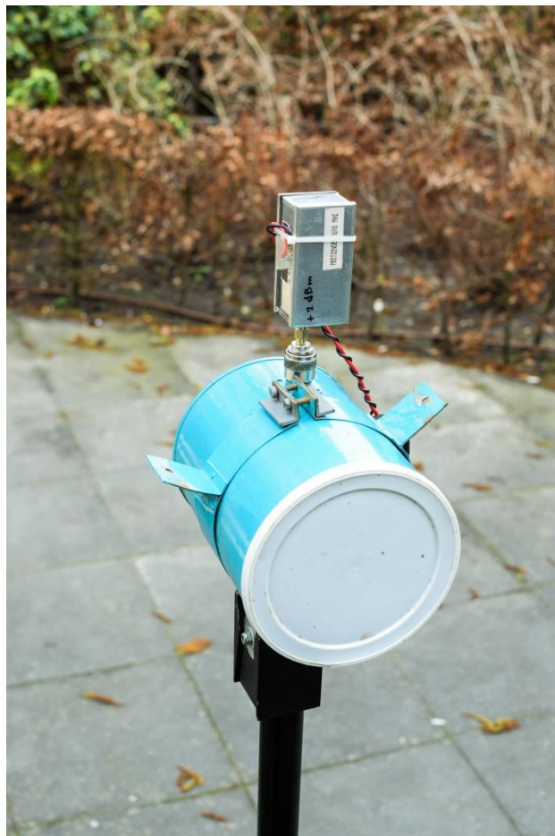
De zendantenne met de 2dBm synthesizer
