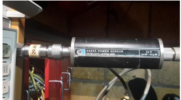
Fig 3 Power Sensor -20dBm tot -70dBm DC-18GHz
