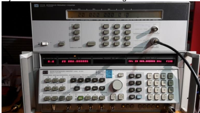
Fig 1 HP8341B Synthesized Sweeper tot 20GHz (met verzwakker tot -110dB), met daarboven de HP5351B Microwave Frequency Counter tot 26.5GHz (met OCXO)
