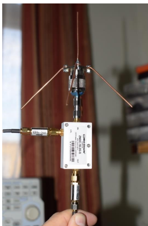
Fig 2 Het gebouwde exemplaar gemaakt van elektriciteitsdraad op een N-female connector met een directional coupler
