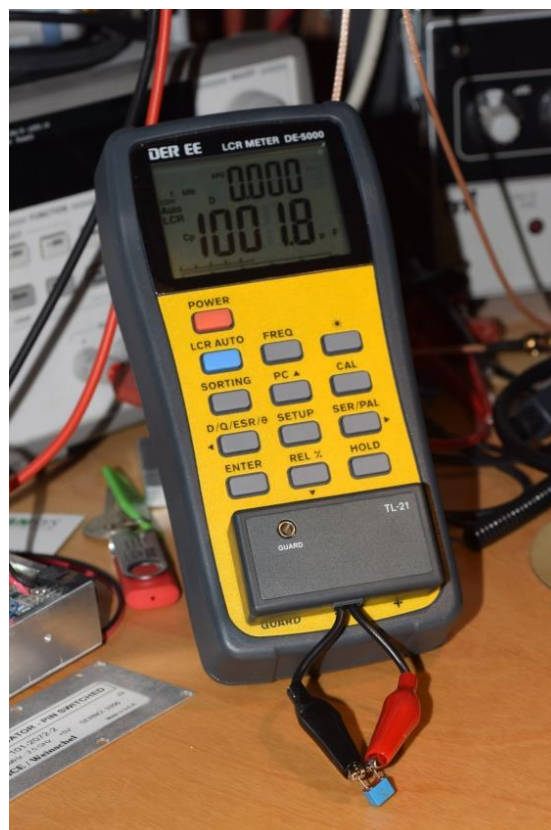
Fig 4 Meter in actie met een 1000 pF "precisie"-condensator
