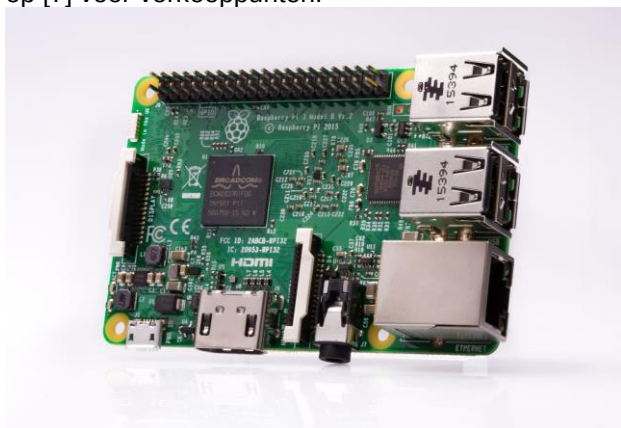
Fig 10 De Raspberry Pi 3. Rechts zie je 4 USB- en de netwerk-aansluitingen. Aan de onderzijde van de print zit een micro-sd kaartlezer.
