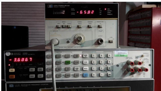
Fig 2 HP436A Power Meter met HP8484A bovenop de HP3556A Digital Voltmeter, 6.5 digits
