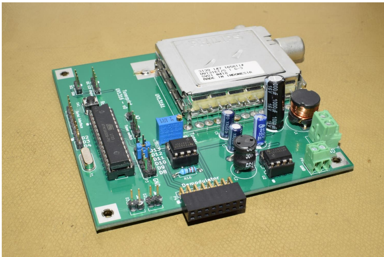
Het opgebouwd prototype. De haakse connector aan de voorzijde verbindt de demodulatorprint.
