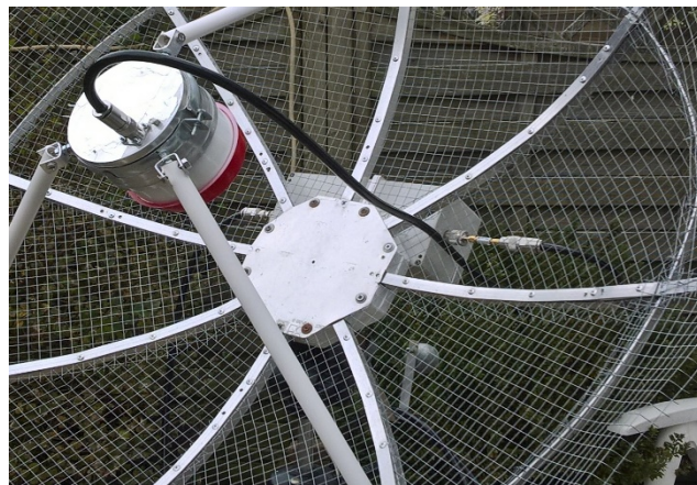
Fig. 1 De (nog niet helemaal afgewerkte) 1,1 meter gaasschotel, die nu gereed gemaakt wordt voor het "buitenleven".
