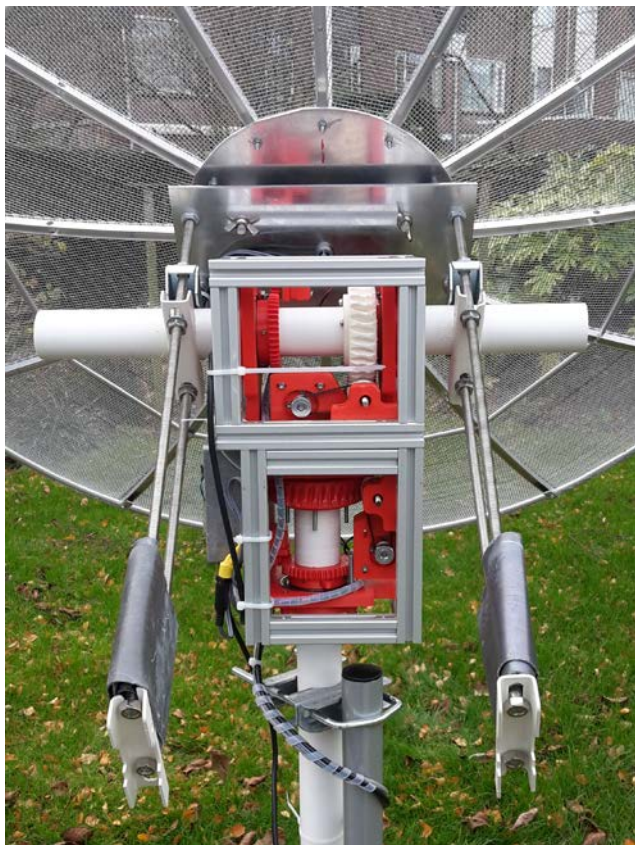
Zelfbouw-rotor van Job, met 3D-geprinte onderdelen en aluminium profielen.
