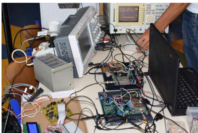
Met een QPSK-meetzer worden de ontvangers van Job de Haas en Peter Smits vergeleken
