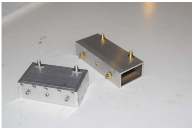
Interdigital filters van Job de Haas. Rechtsboven het model uit aluminium kokerprofiel
