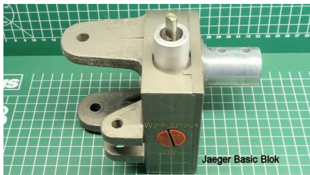
Het Jaeger Basic Blok met de wormaandrukveer
