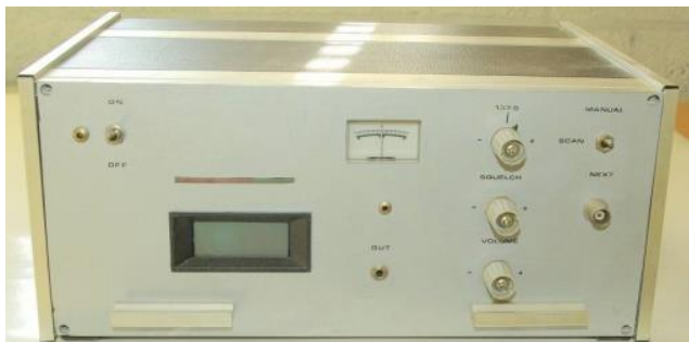
DC 3 NT ontvanger (H. van Deursen) met ingebouwde voeding. Moet wel opnieuw afgeregeld worden. Behuizing h x b x d 13.5 x 32 x 23 cm
