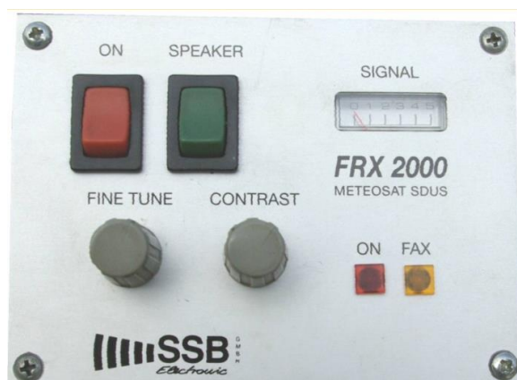
Meteosat Weersatelliet ontvanger FRX 2000 SSB. Moet opnieuw afgeregeld worden. Voeding 12 V
