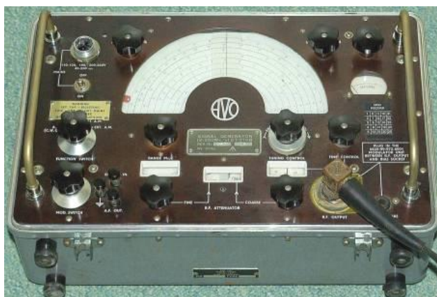
Signaal Generator 378B met voedingskabel en accessoires (2 – 250 MHz) 8 ranges sinus en blok golf
