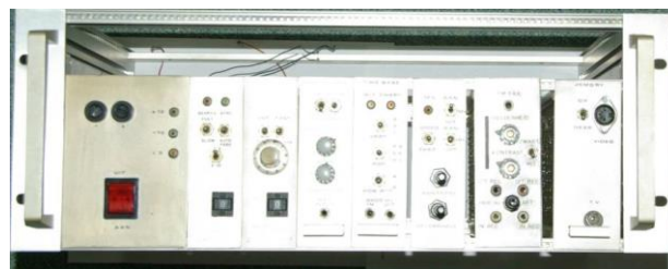
Beeldregistratiesysteem gedeeltelijk omgebouwd van inbrandpapier (facsimile) naar elektrisch gevoelig papier
