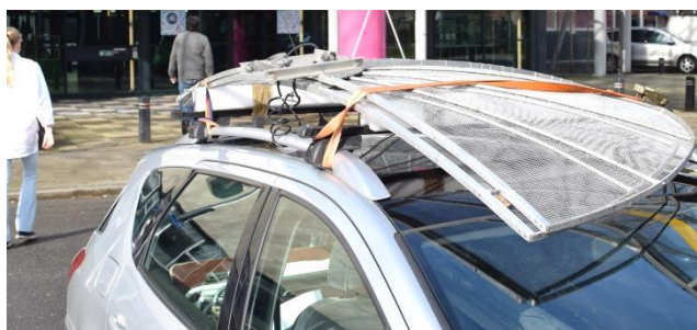
Fig 2 2-meter schotel bestaande uit twee delen
