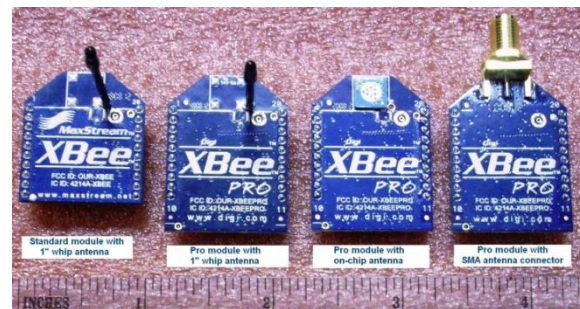
Fig.2 – Diverse antenne uitvoeringen
