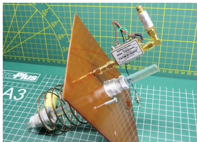
LNA met SMA koppelstuk en filter
