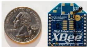
Fig.1 – XBee met draad antenne met 1mW vermogen
