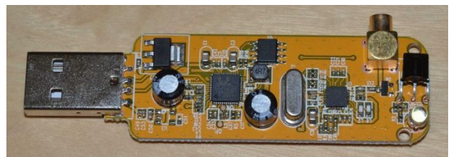
Fig 2 Twee chips doen al het werk
