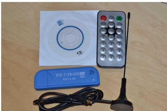
Fig 1 De RTL dongel zoals deze op eBay wordt aangeboden
