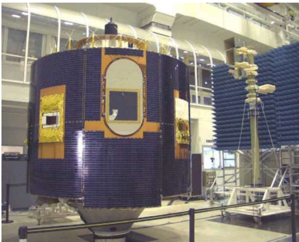
MSG tijdens een rotatie test © ESA
